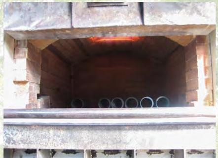
ガス熱処理炉
